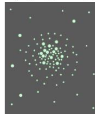
Фотографии люминесцирующего экрана при отсутствии золотой фольги в потоке \alpha - частиц и при ее внесении в поток
