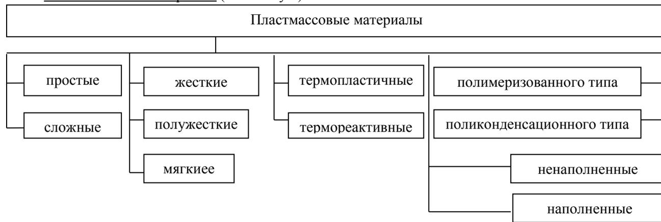
Схема 4. Классификация пластмасс
