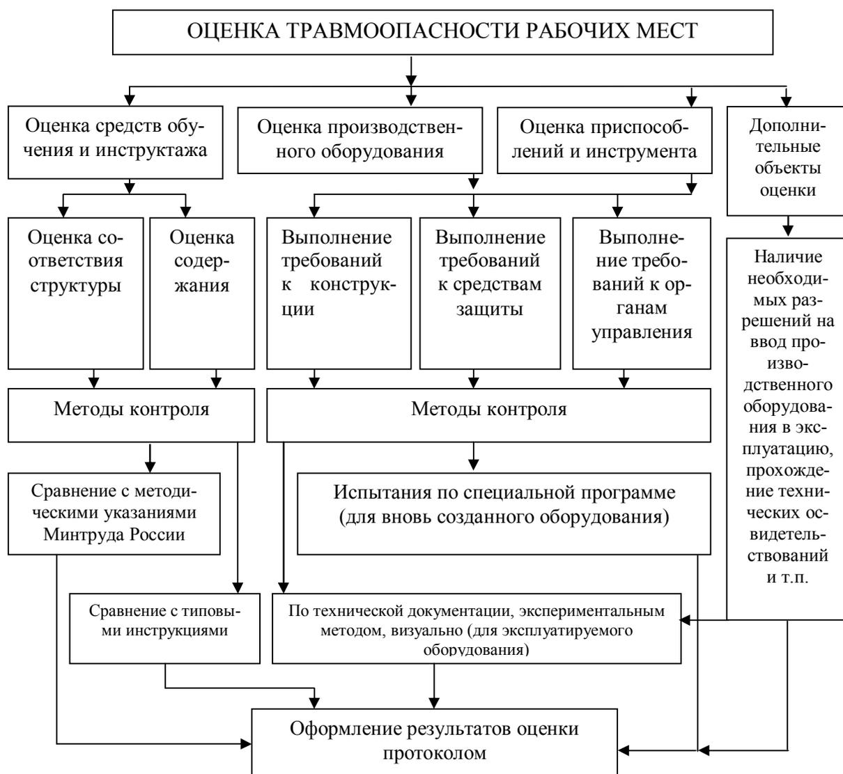
Рис. 1. Общая схема оценки травмопасности рабочих мест
