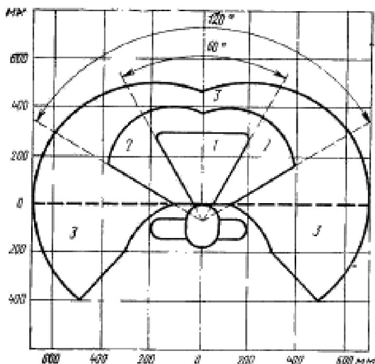
*I* — зона для размещения наиболее важных и очень часто используемых органов управления (оптимальная зона моторного поля); *II* — зона для размещения часто используемых органов управления (зона легкой досягаемости моторного поля); *III* — зона для размещения редко используемых органов управления (зона досягаемости моторного поля)
