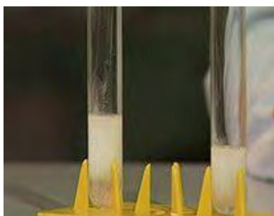
Рис.37. Качественная реакция на ион-цинка с раствором сульфида натрия.
