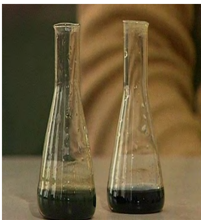
Рис.45. Качественная реакция на ион-железа (III) с раствором сульфида аммония.
