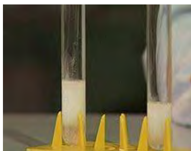
Рис.29. Качественная реакция на ион-калия с раствором винной кислоты.
