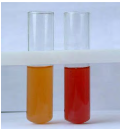
Рис.48. Качественная реакция на карбонат – ион с раствором фенолфталеина.
