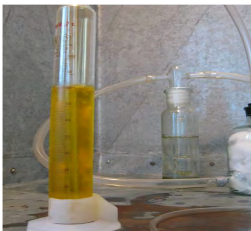
Рис.25. Результат реакции воды с реактивом К. Фишера.
