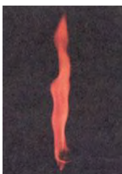
Рис.36. Качественная реакция на ион-кальция (окрашивание пламени горелки).
