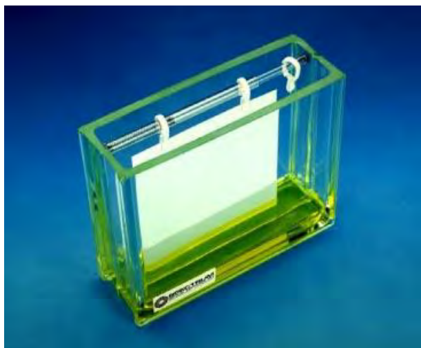
Рис. 68. Прибор для бумажной хроматографии.
