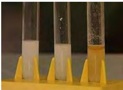
Рис.52. Качественная реакция на йодид-ион с раствором нитрата серебра.
