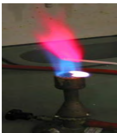
Рис.31. Качественная реакция на ион-калия (окрашивание пламени горелки).
