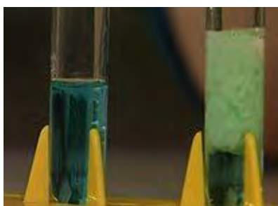
Рис.41. Качественная реакция на ион-железа (II) с раствором гексацианоферрата (III) калия (ферроцианида калия).
