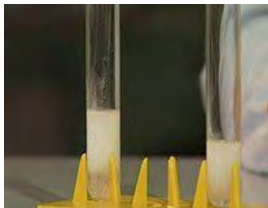
Рис.51. Качественная реакция на сульфат-ион с раствором хлорида бария.
