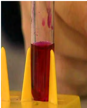
Рис.43. Качественная реакция на ион-железа (III) с раствором тиоционата аммония.
