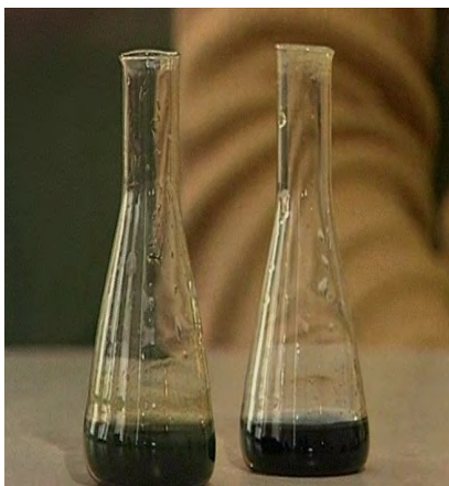
Рис.42. Качественная реакция на ион-железа (II) с раствором сульфида аммония.
