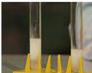
Рис.32. Качественная реакция на ион-серебра с раствором хлорида натрия.
