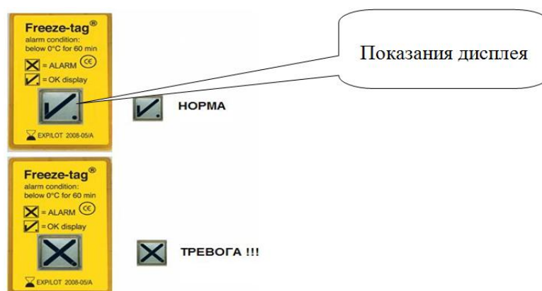
Рисунок 8 - Электронный термоиндикатор Freeze-tag.
