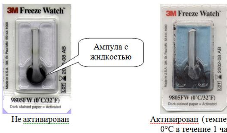
Рисунок 5 - Капиллярный термоиндикатор 3M Freeze Watch™
