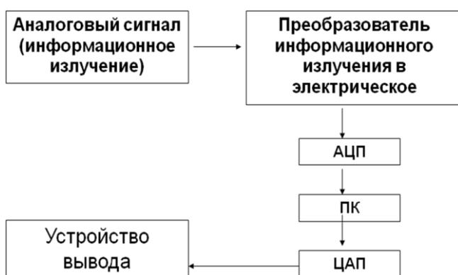
Обратное преобразование осуществляется с помощью ЦАП: при выведение на экран изображения внутренних органов в ходе использования методов визуализации (УЗИ), компьютерной томографии (КТ), получение снимков, переданных по сети.
