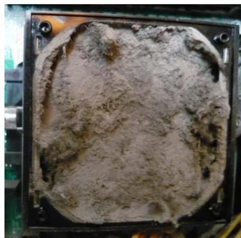
Раскручены четыре винта крепления кулера, кулер снят. Видно, что радиатор забит пылью наглухо.
